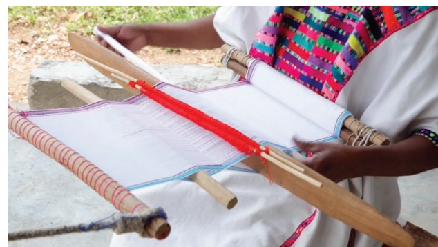
8. SE PASA LA LANZADERA ENTRE LOS HILOS DE LA URDIMBRE PARA FORMAR LA TRAMA THE SHUTTLE IS PASSED BETWEEN THE THREADS TO FORM THE WEFT
