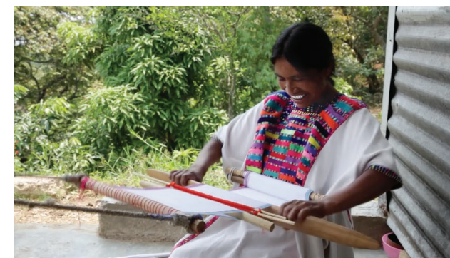
9. CON EL MACHETE DE MADERA SE APIRIETAN LOS HILOS DE LA TRAMA WITH A WOODEN MACHETE THE THREADS ARE TIGHTENED
