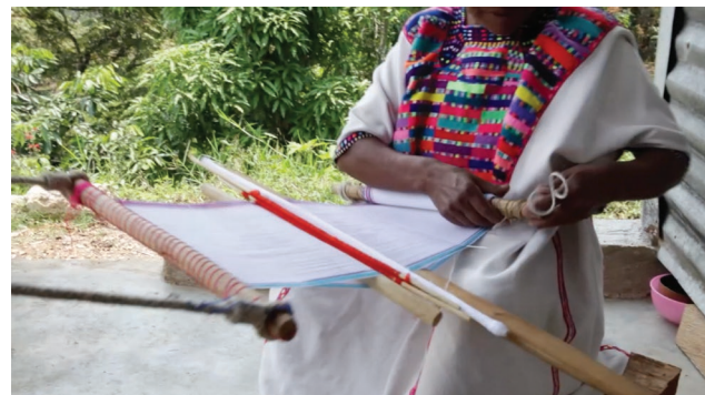
7. EL OTRO EXTREMO SE AJUSTA A LA CINTURA DE LA TEJEDORA MEDIANTE UN MECAPAL THE OTHER SIDE IS ADJUSTED TO THE WEAVERS WAIST WITH A "MECAPAL"
