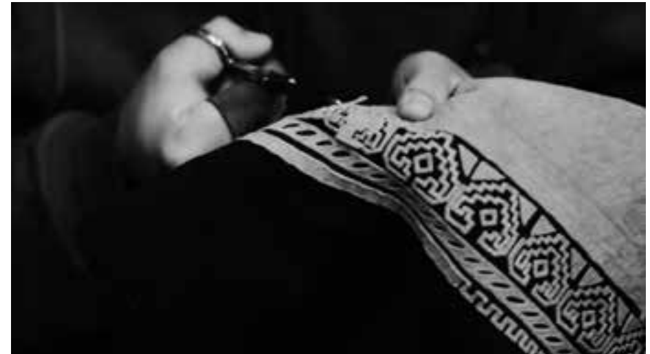
EL CALADO CONSISTE EN "CORTAR" LA PIEL CONTORNEANDO LA COSTURA PREVIAMENTE HECHA.
