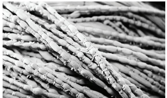
6. HILOS ANUDADOS Y LISTOS PARA SER TEÑIDOS KNOTTED THREADS READY TO BE DYED
